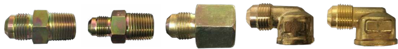
U1-6C-S (steel) 3/8" OD FLARE X 3/8" MIP (TAPPED 1/8" FIP) U1-6D-S (steel) 3/8" OD FLARE X 1/2" MIP (TAPPED 3/8" FIP) U3-6D-S (brass) 3/8" OD FLARE X 1/2" FIP 50-66 (brass) 3/8" OD FLARE X 3/8" FIP ELBOW 50-68 (brass) 3/8" OD FLARE X 1/2" FIP ELBOW
